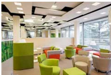
Die Wahl fiel auf das Licht-Akustik-Deckensystem „Soundlight Comfort“ für Bürourumgebungen, das viele Vorteile bietet. Entwickelt wurde es in Zusammenarbeit zwischen Philips, dem weltweiten Marktführer bei Beleuchtungslösungen, und Saint-Gobain Ecophon, dem führenden Anbieter von Akustikdecken. Dieses Deckensystem ist eine innovative Kombination aus Akustikdecke zur Schallabsorption und hochwertiger, energieeffizienter LED-Beleuchtung.
